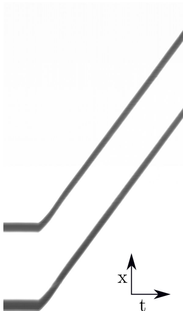
(b) Image obtenue après Reslice, chaque pixel selon l'axe temporel t représente une évolution temporelle de \delta t = \frac{1}{\text{fps}} .
